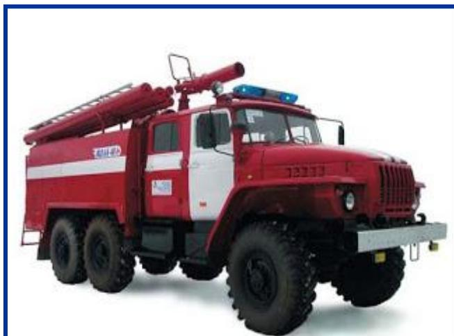
У пожарных есть специальные машины, они снабжены цистерной с водой, баком со специальной пеной, длинными шлангами – рукавами, складной лестницей. Ещё у пожарной машины есть сирена. А для чего же она нужна?
